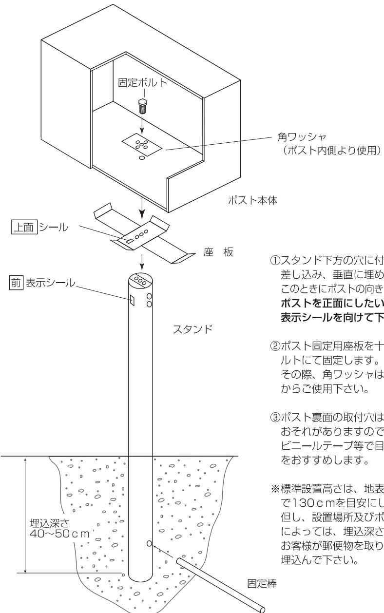
①スタンド下方の穴に付属の固定棒を差し込み、垂直に埋め込みます。
